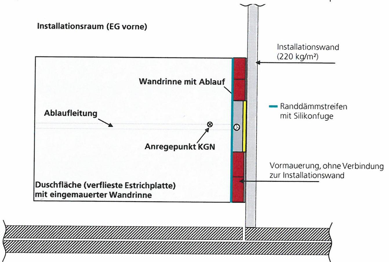
**Bild 3** Oben: Schnitt des Bodenaufbaus (Zeichnung des Auftraggebers)
