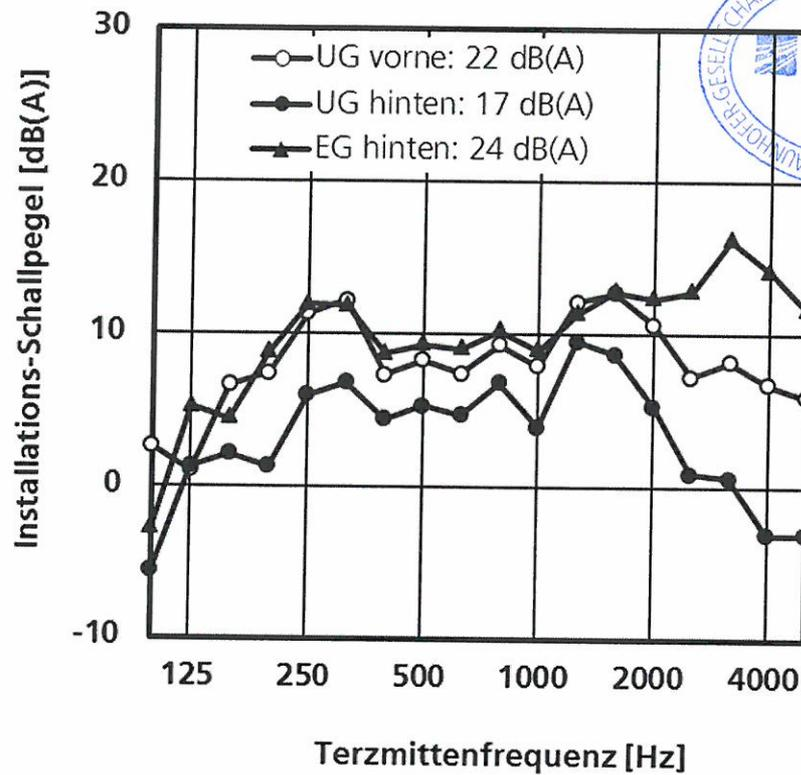
**Bild 2** Wandablauf "Scada" der Firma Kessel AG in massiver Vormauerung, als Bodenablauf für bodenebene Duschflächen. Frequenzverlauf des Schalldruckpegels bei Geräuschanregung mit dem Körperschall-Geräuschnormal (KGN; Betriebsdruck: 3 bar, Durchflussrate: 0,25 l/s), gemessen in den Räumen UG vorne, UG hinten und EG hinten. In der Legende sind die A-bewerteten Gesamtschallpegel für den abgebildeten Frequenzbereich von 100 bis 5000 Hz angegeben.
