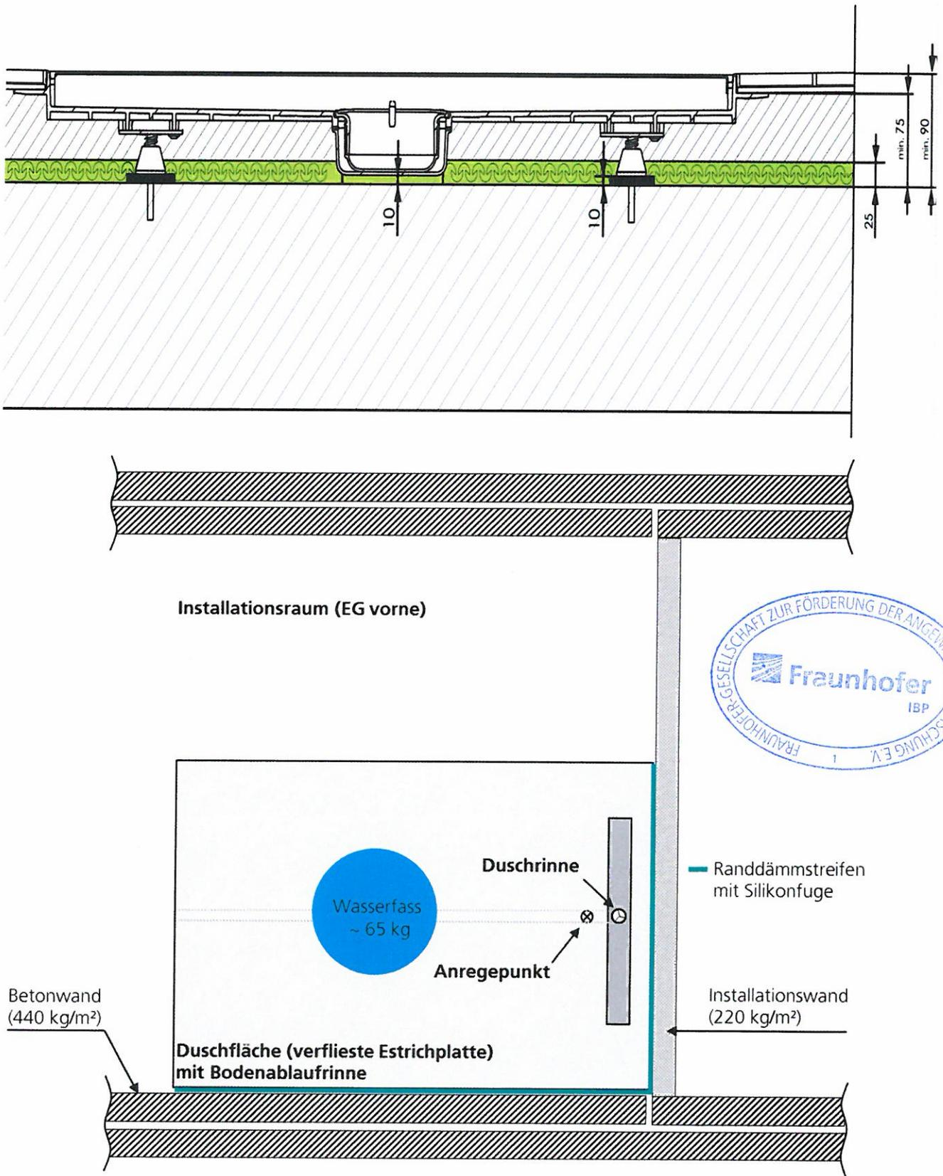
**Bild 3** Oben: Schnitt des Bodenaufbaus (Zeichnung des Auftraggebers)
