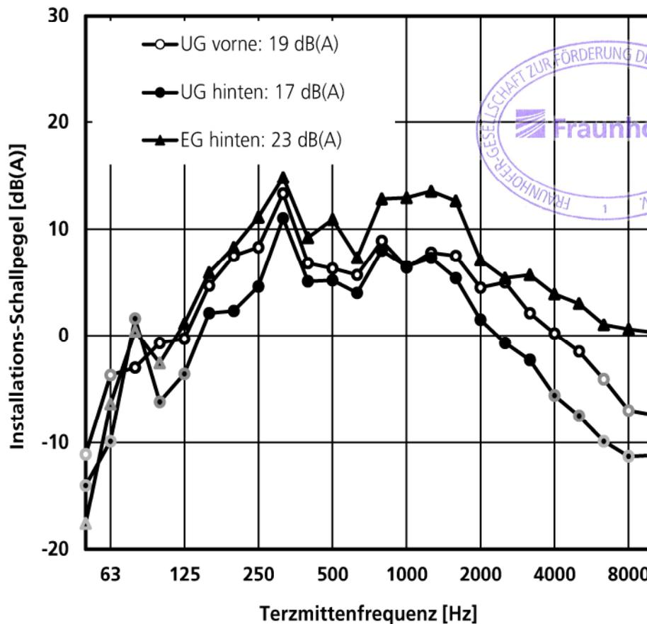
Frequenzverlauf des Installations-Schallpegels bei Geräuschanregung mit dem Körperschall-Geräuschnormal (KGN), gemessen in den Räumen UG vorne, UG hinten und EG hinten. In der Legende sind die Installations-Schallpegel  $L_{AFeq,n}$  in dB(A) nach DIN 4109 für den abgebildeten Frequenzbereich von 100 bis 5000 Hz angegeben.
