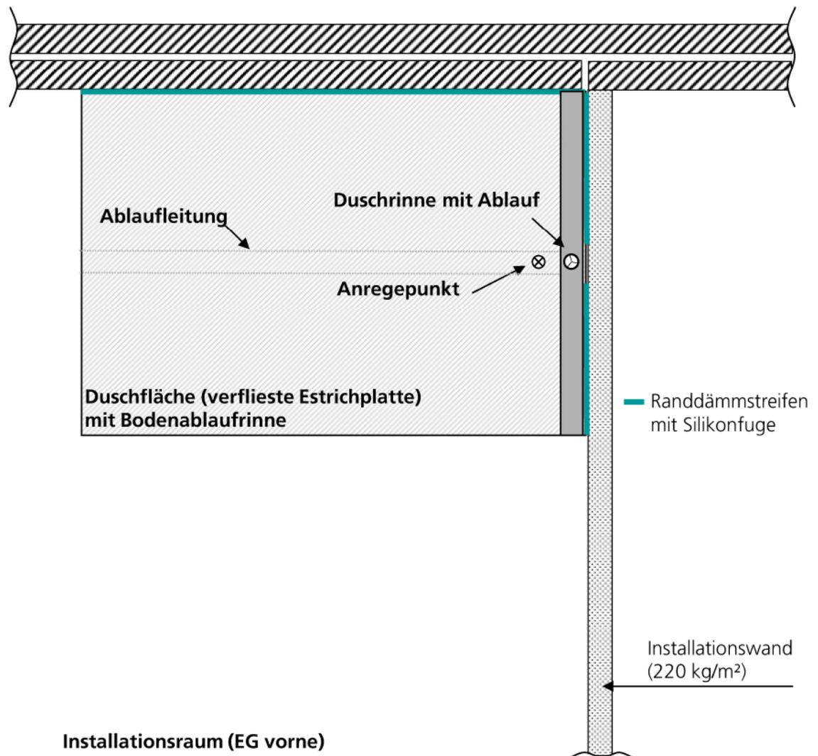
Lage des Prüfaufbaus im Installationsraum (EG vorne).
