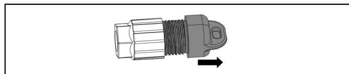
**DE:** Beiliegende Distanzringe gemäß Farbcodierung der Distanzringe am Schaltgerät auswählen und (ggf. beidseitig) auf Verlängerungsstecker aufziehen.
