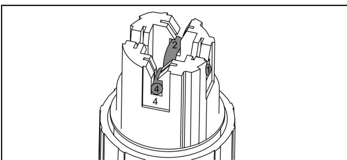
**IT:** Condurre i cavi (eventualmente attraverso un tubo vuoto). A tale fine, togliere il cappuccio di protezione (1), scegliere i connettori adatti (codifica cromatica dell'anello distanziatore) e allineare "freccia su freccia" o "punta su punta" (2). Serrare i connettori (3) tenendo conto del gioco e del momento torcente illustrato.
