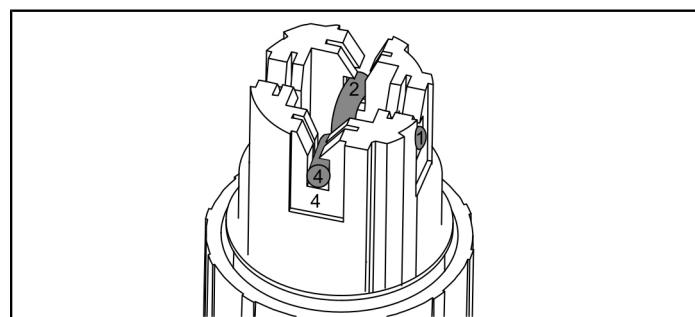
**DE:** Kabel (ggf. durch Kabelleerrohr) heranführen. Hierfür Schutzkappe abziehen (1) passenden Stecker auswählen (Farbcodierung des Distanzringes) und "Pfeil auf Pfeil" oder "Spitze auf Spitz" ausrichten (2). Stecker festziehen (3), dabei abgebildetes Spaltmaß bzw. Drehmoment beachten.
