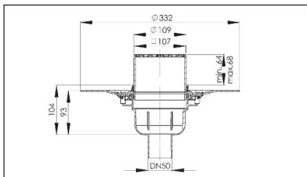
Ausführung mit Klebeflansch
